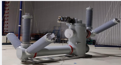
采用压缩空气为绝缘介质的清洁高压开关产品
