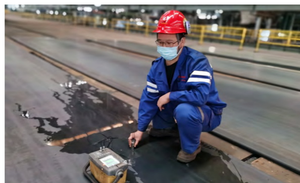
质量检测人员正在对刚生产出来的稀土耐磨钢进行细致全面的检测
