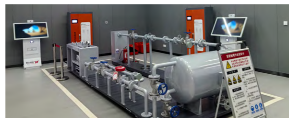
包钢股份安全体感中心 - 盲板抽堵作业安全实训系统
