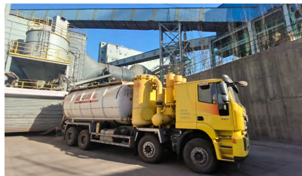
对于无直接利用价值的除尘灰，采用吸排罐车进行全密闭式收集转运
