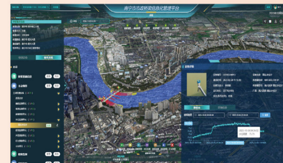
▲ 防撞预警平台实时获取桥区水位情况
