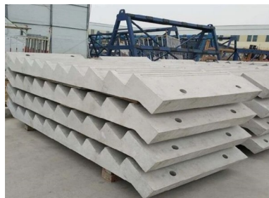
项目采用装配式预制楼梯
