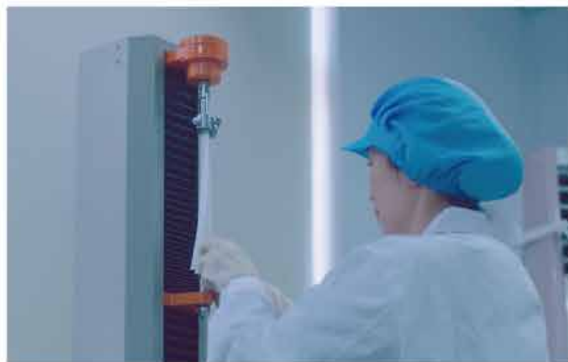
公司品控人员使用抗张实验机对成品纸开展拉力测试
