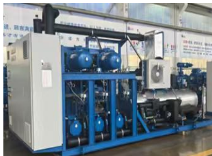
CO 2 制冷压缩机组
