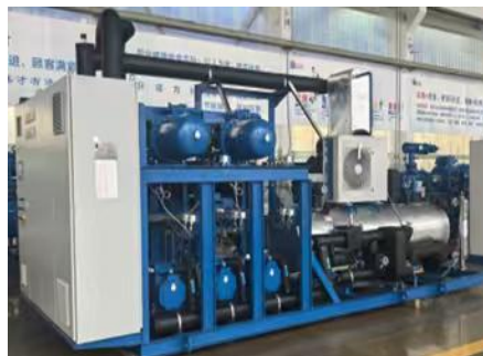
CO 2 制冷压缩机组
