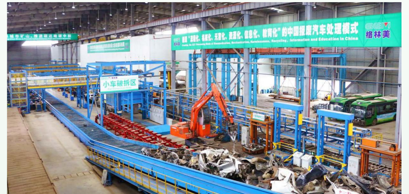
▲ 格林美报废汽车绿色拆解产线
