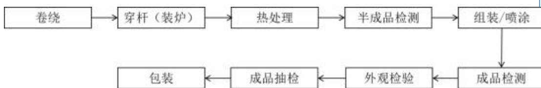
⑤ 软磁复合磁粉芯的主要工艺流程
