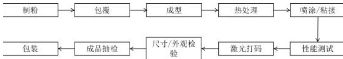
⑥ 共模电感的主要工艺流程
