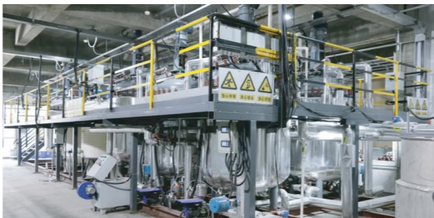
索通发展山东临邑基地“从复杂铝电解质中提取锂盐新技术”中试生产线
