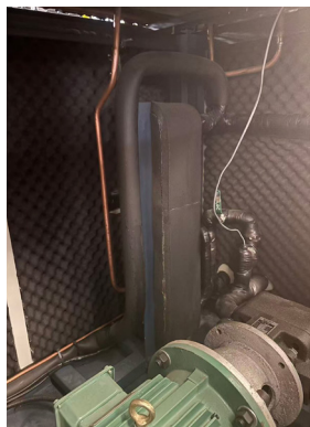
华阳密封生产部试验台隔音棉
