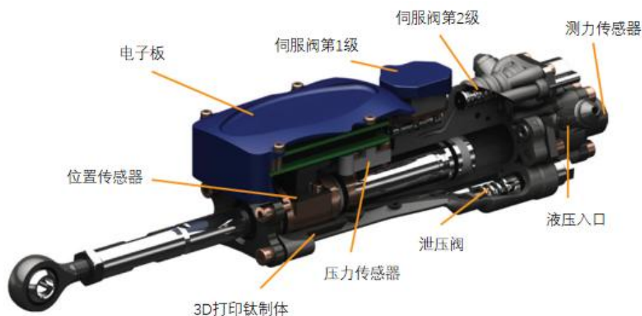
电液驱动关节结构示意图
