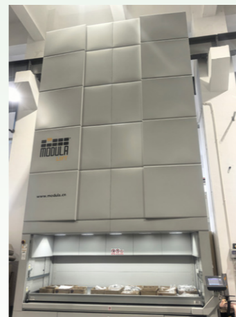
上线五金零部件数字化管理的智能立体库
