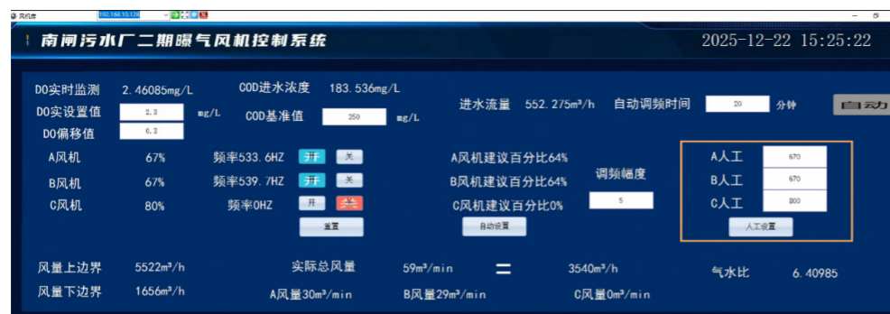
污水处理厂精确曝气系统
