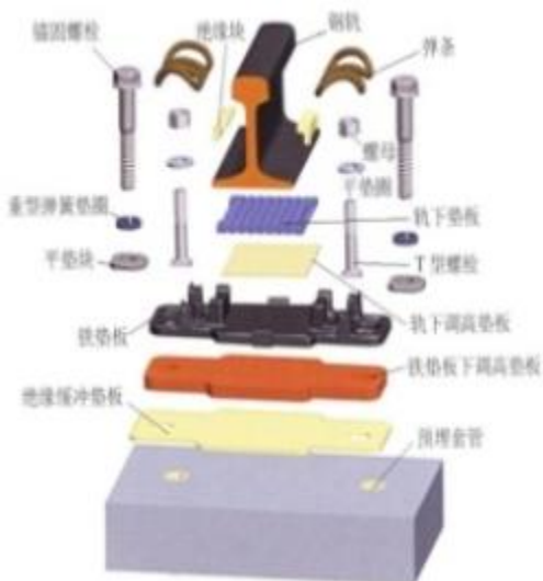
WJ-7型扣件组装零件图
