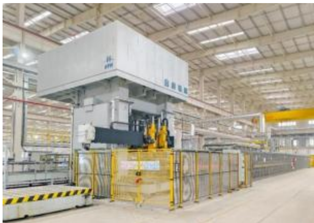
超高强钢热成形生产线
