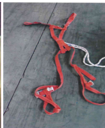
整改后 更换适用于现场作业 高度的安全带
