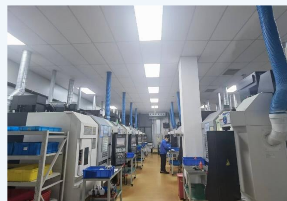
废气油雾&无极粉尘：经废气管路、静电除油设备 + 活性炭吸附装置处理后外排
