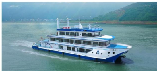
50 米氢燃料电池动力工作船
