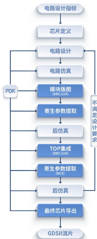
图 9：蓝色方框步骤为芯片版图设计步骤
