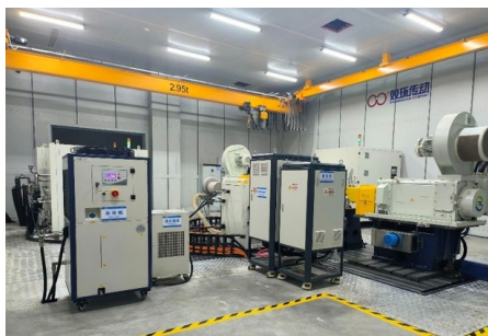
高速三电机试验台
