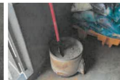
▲ 泄漏后的化学品及黄沙的混合物, 妥善存放至危险废物库房
