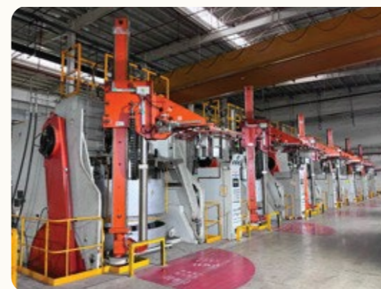
中化橡胶供越南客户的105吨单模机械式硫化机在生产现场
