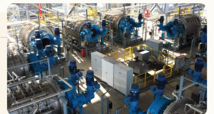
全球首台套超大型液力式旋转压力过滤机
