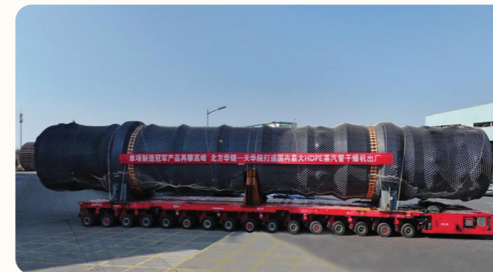
国内最大高密度聚乙烯 (HDPE) 蒸汽管干燥机
