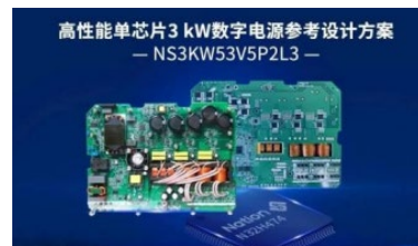
高性能單晶片 3 kW 數字電源參考方案
