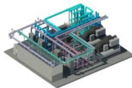
装配式高效中央空调机房
