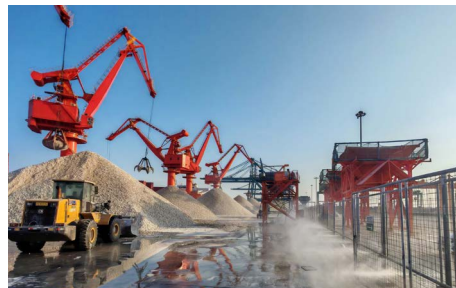
秦港股份雜貨公司自主研發的 港區場道智能噴淋濕潤抑塵系統
