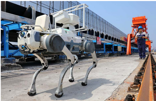
秦港股份九公司工作人員在堆場內對四足巡檢機器人進行作業前例行檢查
