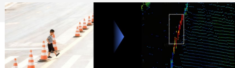
传统 SPAD 方案：算法误滤除引起漏报
