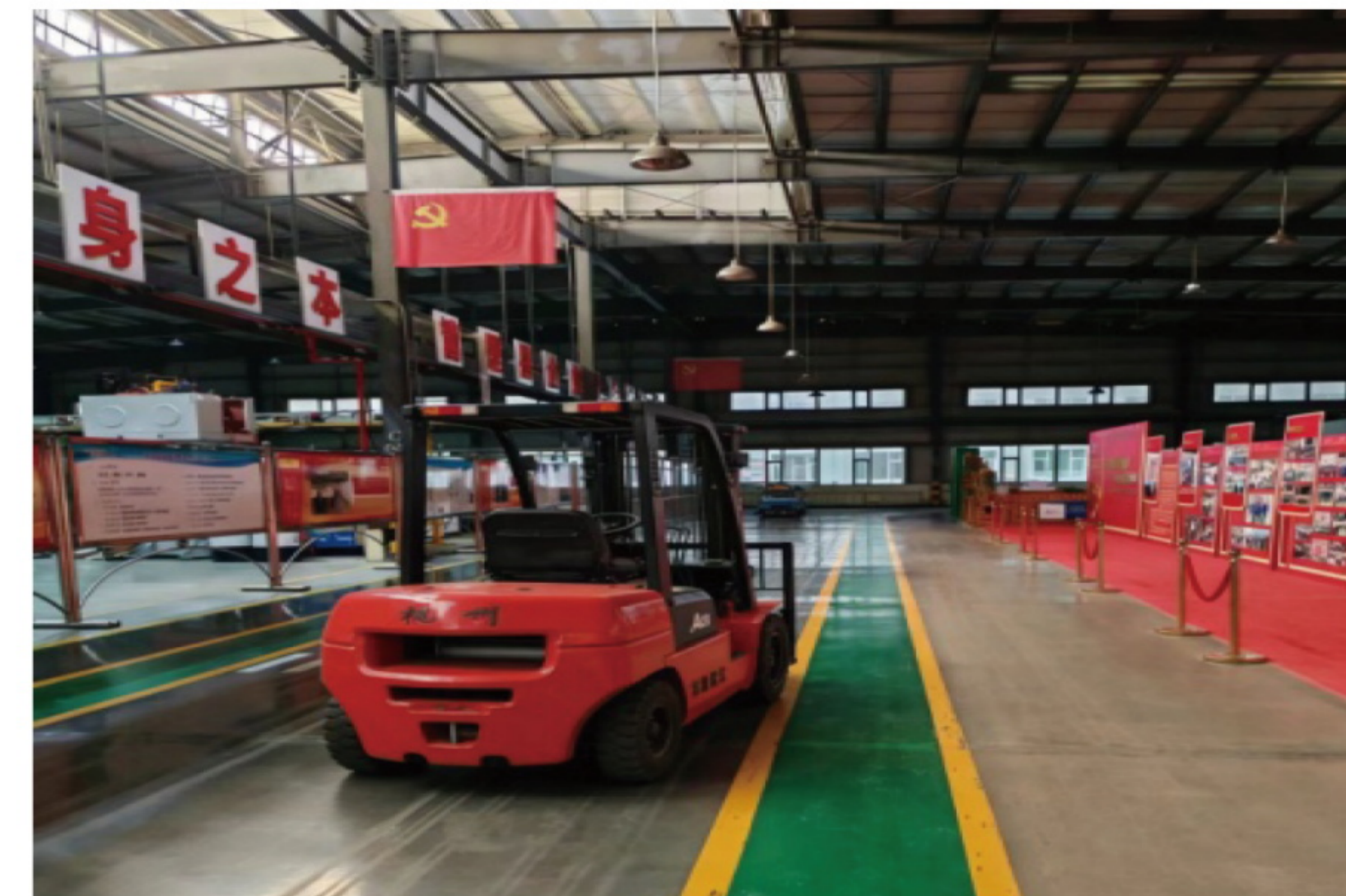
完成厂区内三台叉车“油改电”升级，减少年碳排放约20700千克，改善作业环境空气质量，消除叉车运行噪音，保障员工健康。
