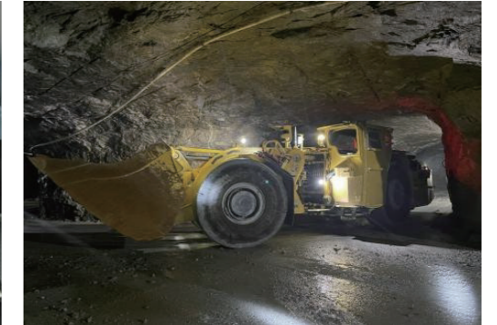
井下智能铲运机作业现场
