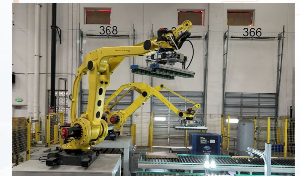
机械臂拆码垛贴标流水线
