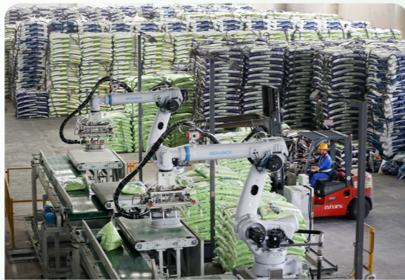
新洋丰硫酸钾复合肥厂生产车间内自动码包机器人正在高速运转
