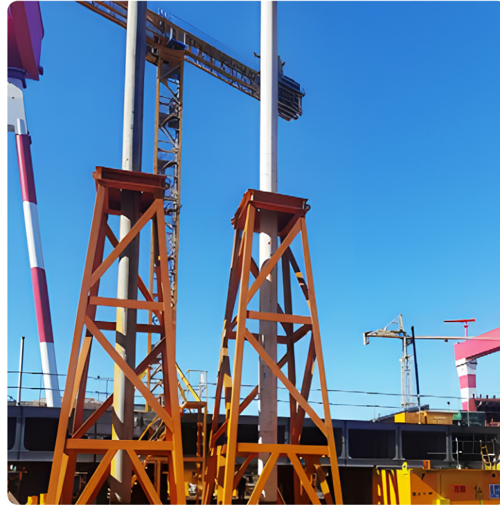
采用螺旋支撑结构的稳箱架
