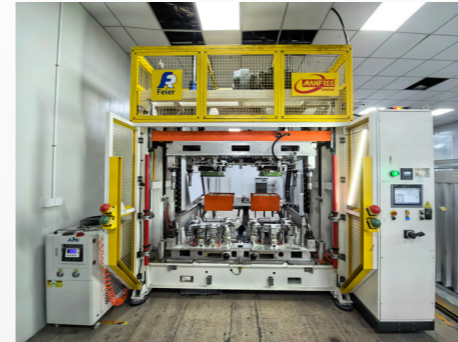
上工飞尔包覆热压设备
