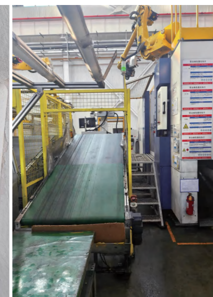
注塑机与传送带联动控制
