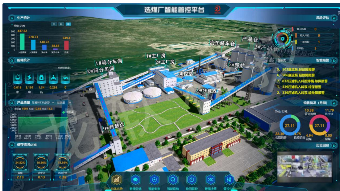
图 3-15 智能化选煤厂管控系统
