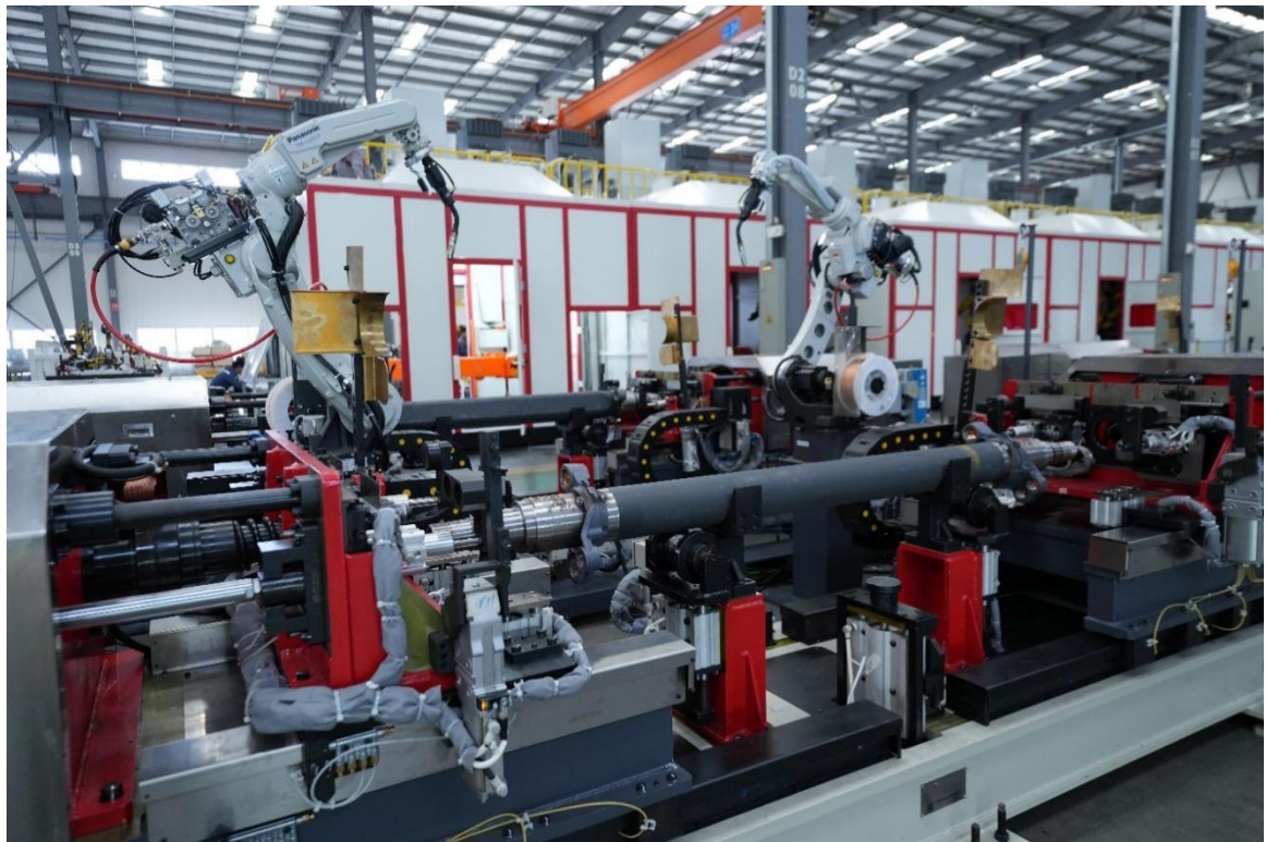
图：重卡车辆承重部件生产线项目
