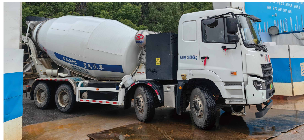
新能源混凝土运输车辆
