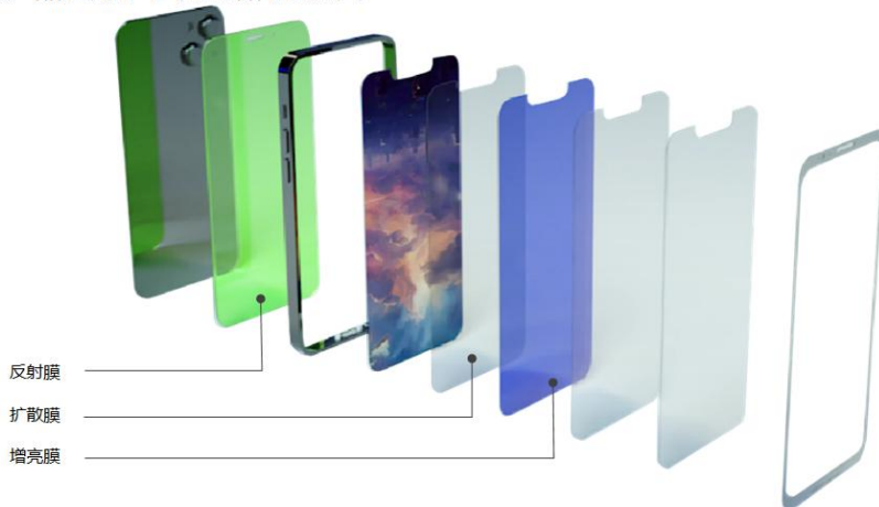
公司产品应用于手机的结构示意图
