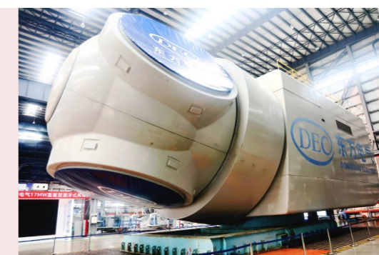
17兆瓦直驅型漂浮式海上風電機組
