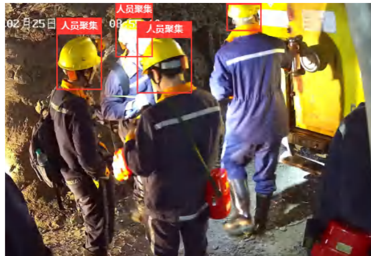
井下 AI 视频监控系統监测到人员聚集进而报警
