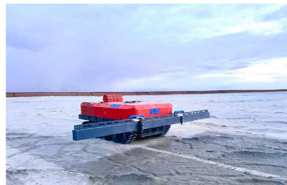
内蒙古矿业公司研发 CG/HJ 复合抑尘剂与 CG/HJ 智能抑尘机器人，打造高寒尾矿库智能化抑尘系统。
