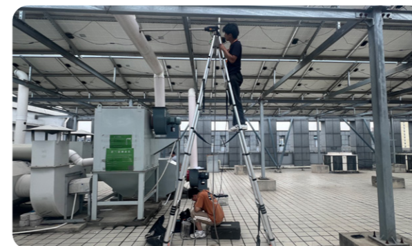
废气检测现场取样
