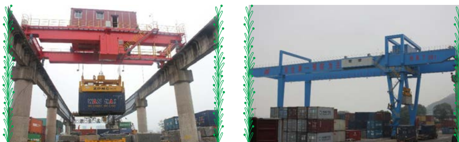
高要港 - 用於處理貨櫃的軌道式龍門起重機(RMG)及橋式起重機
