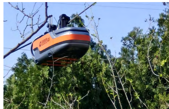
郭二庄矿智能涂覆机器人在高空作业
