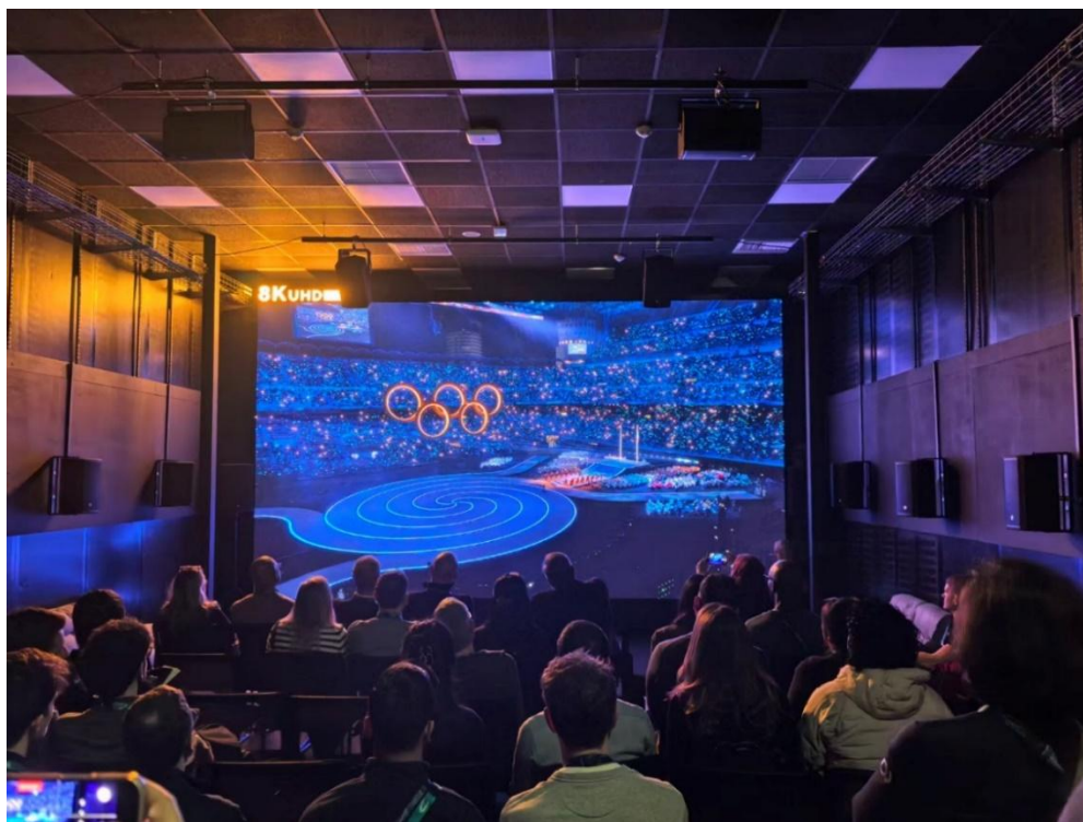
2026 年米兰冬奥会央视总台 8K 转播平台——雷曼光电 275 吋 8K Micro LED 大屏
