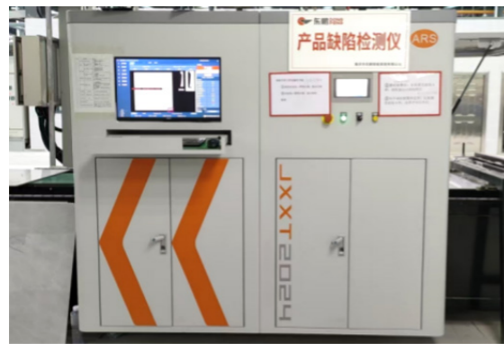
东鹏瓷砖智能缺陷检测设备
