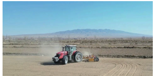
在宁夏平原，徐工 XT2204-6DK 拖拉机牵引平地机，为玉米播种进行平地作业。
