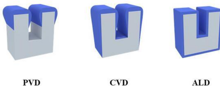
PVD、CVD、ALD 薄膜沉积效果示意图
