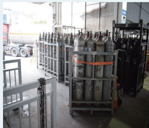
发现安全隐患 (普气车间疏散通道上摆放了大量瓶框)
