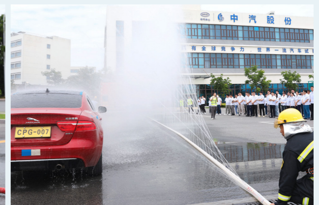
自研“新能源车辆底盘灭火降温装置”及水幕水带的使用
