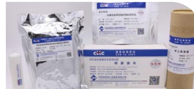
标准棉摩擦布、抗菌控制织物、酚黄测试组件等标准样品
